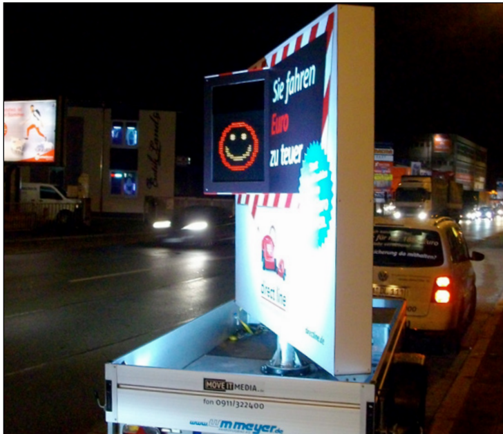
Das schwenkbare RadarPlakat misst die Geschwindigkeit
